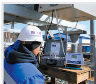
Работа с приборами ПКВ/М7 и ПУВ-регулятором во время испытаний выключателя при пониженном напряжении с определением величины минимального напряжения срабатывания.
