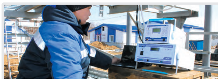
Работа с приборами ПКВ/УЗ.1 и ПУВ-регулятором во время испытаний выключателя при пониженном напряжении с определением величины минимального напряжения срабатывания.
